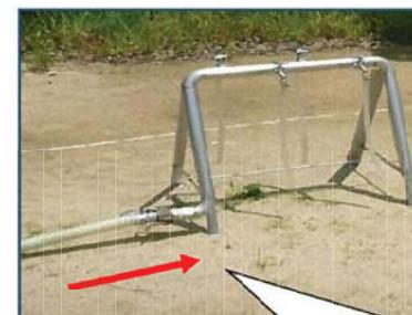
・差し込んだ状態でカムロック（接続金具）のレバーを左右同時に手前（ホース側）に閉じる。
